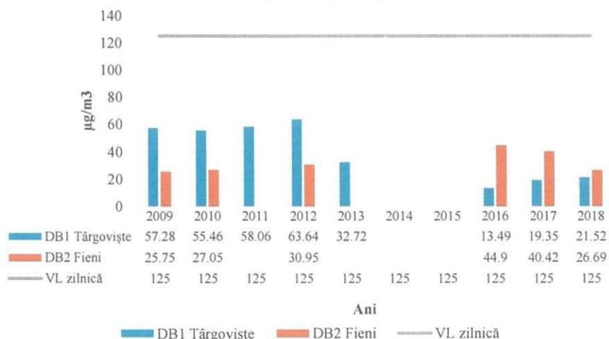
Figura - 26 Valorile maxime zilnice ale indicatorului SO 2 raportate la valoarea limită zilnică pentru protecția sănătății umane, în perioada 2009-2018 (Sursa: Rapoarte anuale privind starea mediului în județul Dâmbovița 2009-2017, APM Dâmbovița, Raport privind calitatea aerului înconjurător în județul Dâmbovița pentru anul 2018, APM Dâmbovița)
